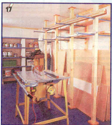
17 Между стеной и стойками стеллажа хранятся ДСП, фанера, ДВП и т.п., над ними – доски, рейки, бруски.
