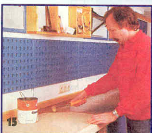
15 Поверхность рабочей плиты обрабатывают виброшлифовальной машинкой, а затем покрывают прозрачным лаком в три слоя.
